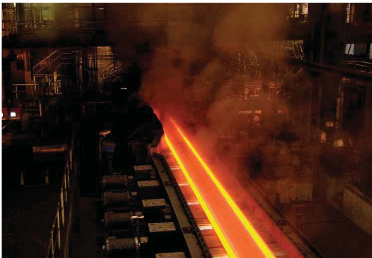
Laminage d'une poutrelle H1STAR au train Grey de l'usine de Differdange, Luxembourg
