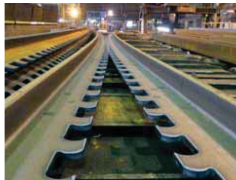
Séparation de 2 demi-poutres PreCoBeam dans les ateliers de finissage d'ArcelorMittal.
