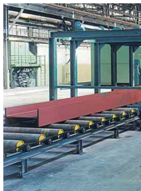
Installation de traitement de surface automatique – Grenaillage et application d'une couche de peinture
